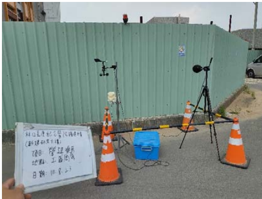
監測項目：營建噪音(111年8月) 監測地點：工區周界
