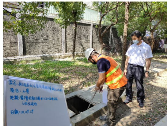
監測項目：放流水(111年第3季) 監測地點：質子暨放射治療中心污水處理系統之放流池
