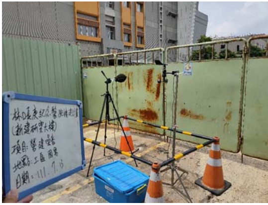
監測項目：營建噪音(111年7月) 監測地點：工區周界
