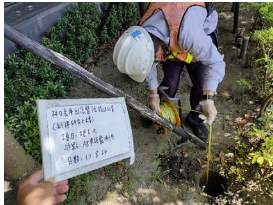
監測項目：地下水(111年第3季) 監測地點：A8車站監測井
